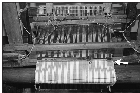
Obr. 4. Detail tkalcovského stavu s dvojdílnou stavitelnou rozpínkou na osnově, 19. století. Muzeum a galerie Orlických hor, Rychnov nad Kněžnou. Foto J. Ouřada. Šípkou vyznačena rozpínka. Fig. 4. Detail of loom with two-part adjustable loom temple on the threads, 19th century. Orlické Hory Museum and Gallery, Rychnov nad Kněžnou. The loom temple indicated by arrow.
